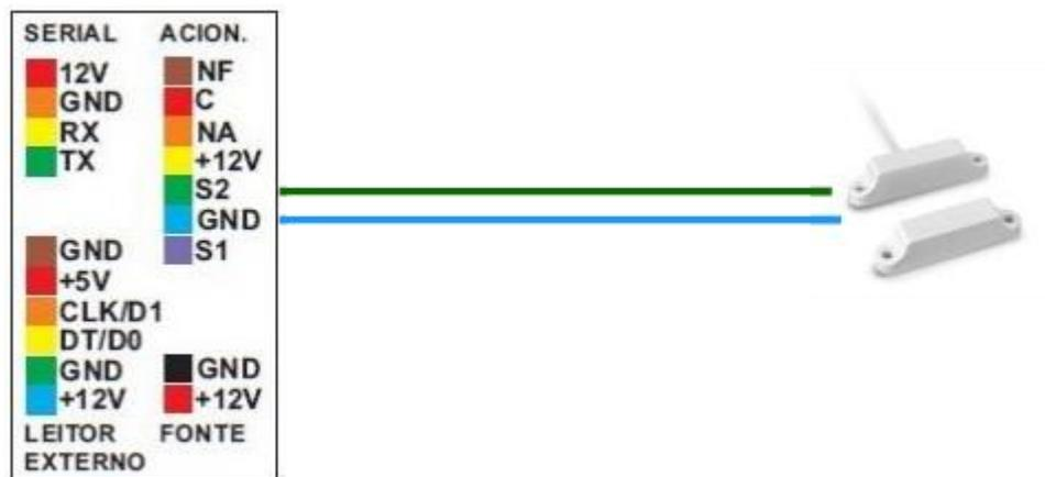
Por padrão, o Inner Acesso 2 sai de fábrica com o sensor de porta desabilitado, podendo ser habilitado através do Web Server ou do software Gerenciador de Inners. O sensor de porta funciona em modo online e offline.
