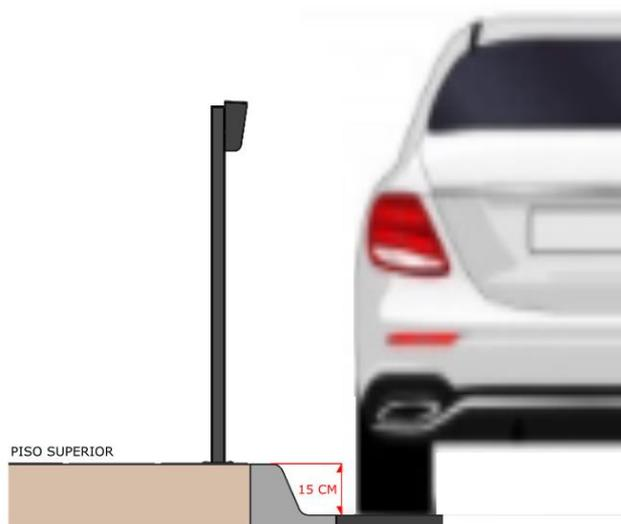
Na base do Totem encontram-se 4 furos de diâmetro 9 milímetros para a passagem de fixadores, escolha a melhor forma de fixação com o propósito de garantir que o pedestal fique firme no piso.
