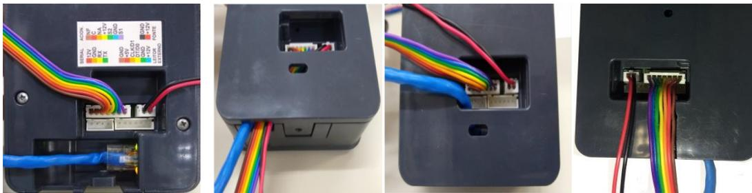
Para os modelos de Inner Acesso 2 com comunicação de rede Wi-Fi, o cabo de rede precisa estar conectado somente ao fazer as configurações iniciais no Web Server, referente a comunicação com a rede Wi-Fi. Após essa configuração não é necessário manter o cabo de rede conectado ao equipamento. Caso o cabo de rede permaneça conectado e a comunicação Wi-Fi também, a comunicação ocorrerá primeiro via cabo, ou seja, a conexão via cabo tem prioridade sobre a Wi-Fi.
