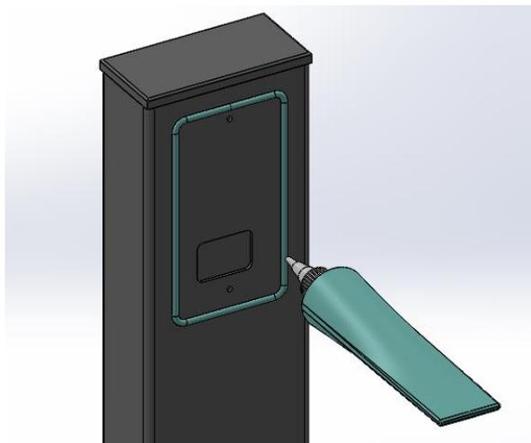
Depois de aplicar o silicone no pedestal, monte o gabinete junto com o suporte da parede na seguinte sequência de montagem.
