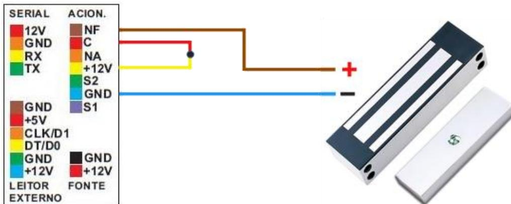
**ATENÇÃO:** A capacidade da fonte deve ser suficiente para suprir o consumo do Inner Acesso 2 e da fechadura. Para fechaduras com alimentação diferente de 12V utilizar alimentação individual conforme recomendação do fabricante. Neste caso utilizar o seguinte esquema de ligação:
