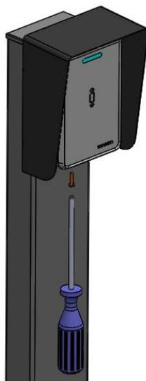
O Totem deve ser instalado em uma superfície elevada de aproximadamente 15 centímetros de altura para facilitar o acesso aos leitores pelo usuário que estará dentro do automóvel. Veja exemplo a seguir:
